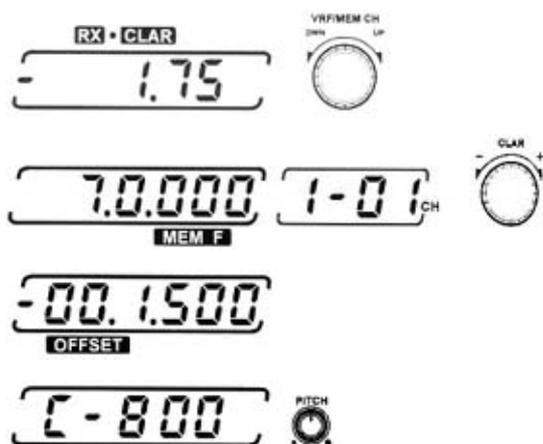
**Смещение расстройки.** Три цифры отображают смещение расстройки приемника или передатчика ( $\pm 9.99$  КГц), которое будет применено к рабочей частоте.
