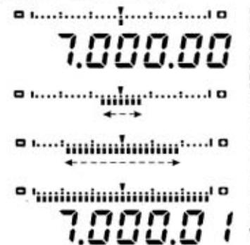
Скорость и расстояние между размещенными сегментами в любом виде излучения пропорциональна установленному шагу настройки и зависит от того нажата или нет кнопка [FAST]. Режим сегментного индикатора определяется в пункте меню трансивера 3-2.
